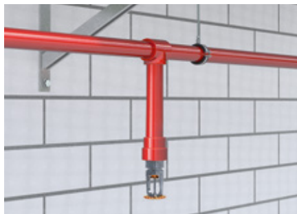
Befestigung von Sprinkleranlagen
